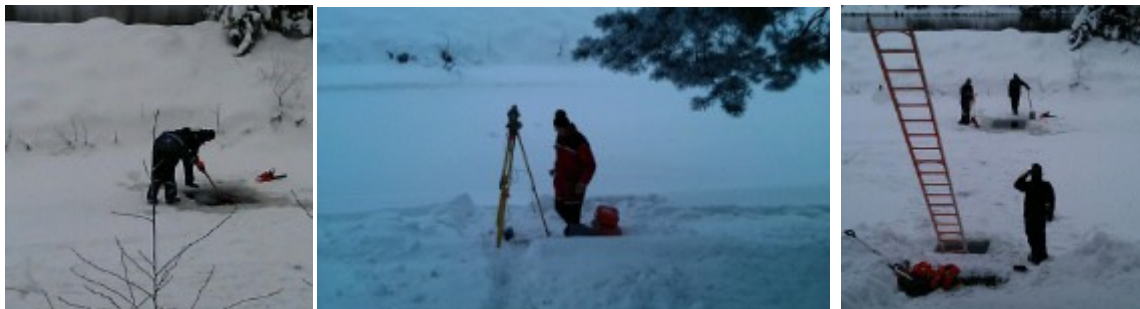
Bilder: For å kunne detaljprosjekttere, måtte vi videofotografere bunnen og foreta oppmåling av dybdeforholdene. Det ble skjært fire hull i isen og dykker gikk med kamera sendt ned. En kald fornøyelse! 1.feb-2012
